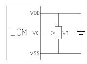
$V_{\text{DD}\sim}V_0$ : LCD Driving voltage
